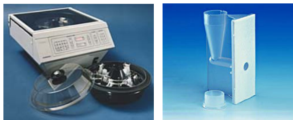
Bild 4: Shandon CytoSpin 3 från Thermo Scientific med avsedda filter.
